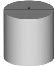
*Slika 2.5.3.4 Oblik fragmenata aproksimiran cilindrom sa visinom jednakoj prečniku  $a_{ekv}$  baze cilindra*
