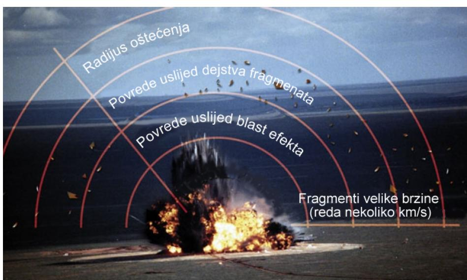
Slika 2.7.5.1 Zone oštećenja uslijed blast efekta i dejstva fragmenata nakon eksplozije bojeve glave
