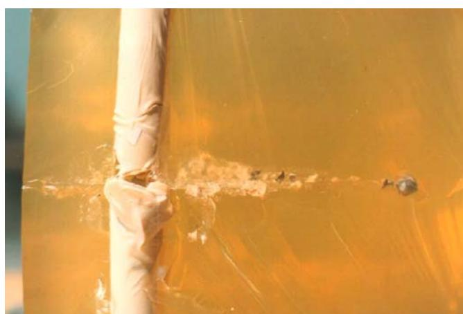
Slika 2.8.2.2 Penetracija sintetičke kosti [32]
