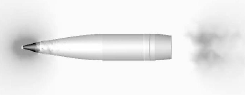
Strujnice oko osnosimetričnog brzorotirajućeg projektila
